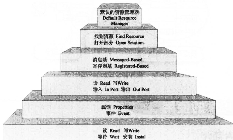
图 16-29 VISA 内部结构示意图
